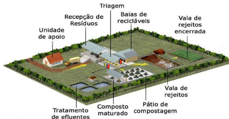
Figura 72: Estruturas da Usina de Triagem e Compostagem.
