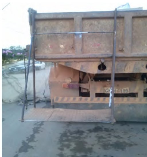
Figura 121: Plataforma de segurança instalada no caminhão de coleta.
